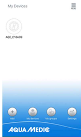
Рис. 13: в пункте меню «My groups» можно объединить несколько помп в группу и запрограммировать их вместе.
