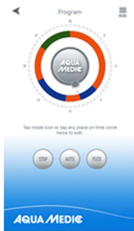
Рис. 10: коснитесь символа «STOP, AUTO, FEED» или дважды коснитесь круга, чтобы изменить соответствующий период.
